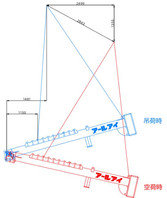
BBバランサー6700 4t吊り概算変動図
