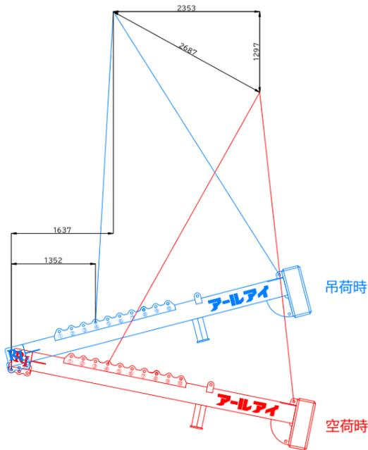
BBバランサー6700 3.5t吊り概算変動図
