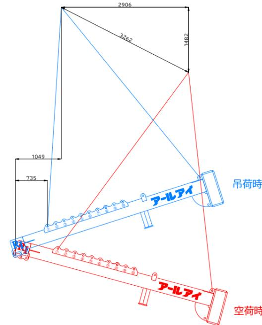
BBバランサー-6700 6t吊り概算変動図
