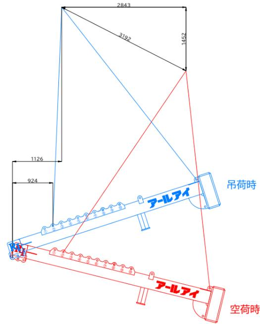
BBバランサー-6700 5.5t吊り概算変動図
