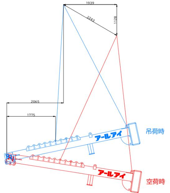
BBバランサー6700 2.5t吊り概算変動図
