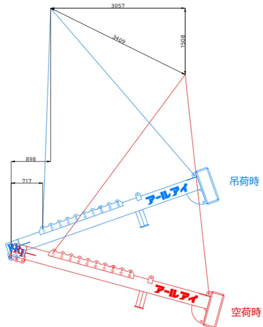
BBバランサー-6700 6.7t吊り概算変動図
