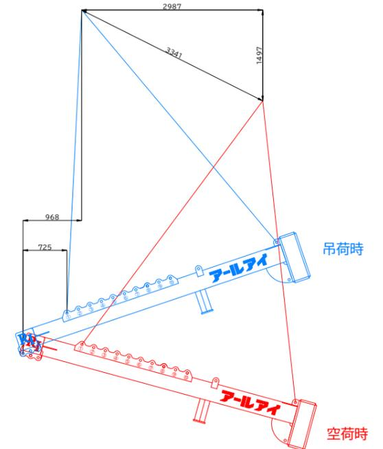
BBバランサー-6700 6.5t吊り概算変動図
