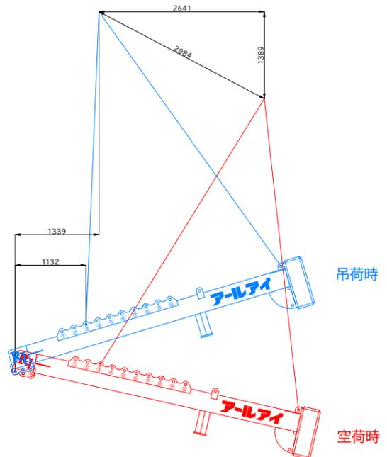
BBバランサー-6700 4.5t吊り概算変動図
