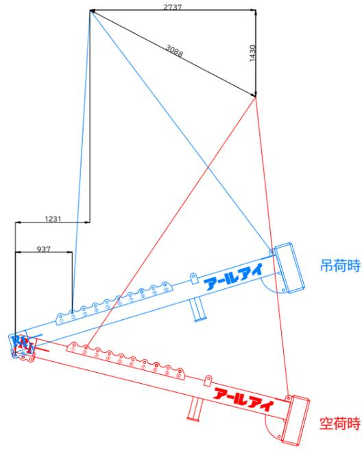
BBバランサー-6700 5t吊り概算変動図
