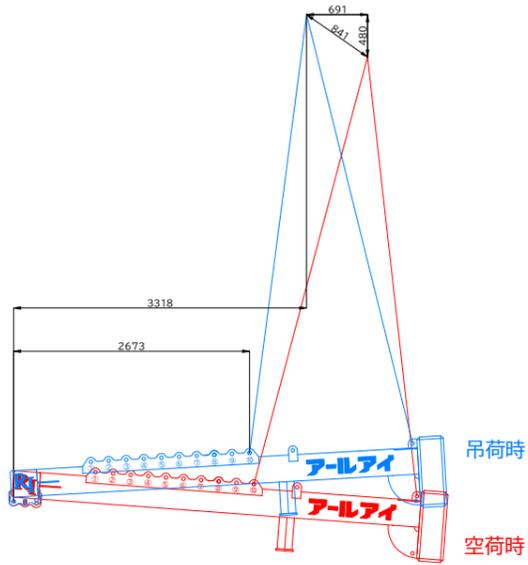
BBバランサー6700 1t吊り概算変動図
