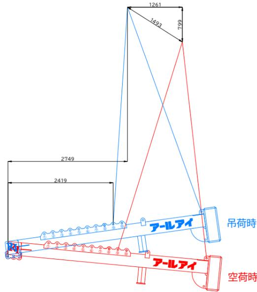
BBバランサー6700 1.5t吊り概算変動図
