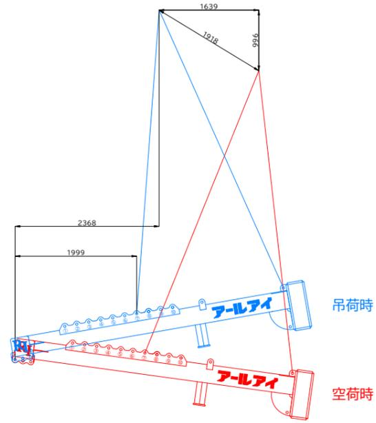
BBバランサー6700 2t吊り概算変動図
