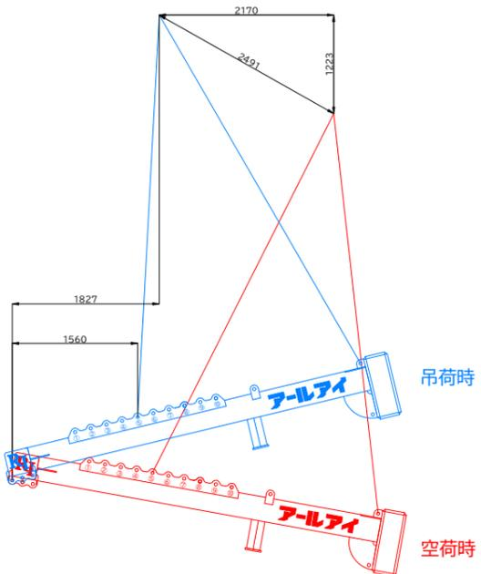
BBバランサー6700 3t吊り概算変動図
