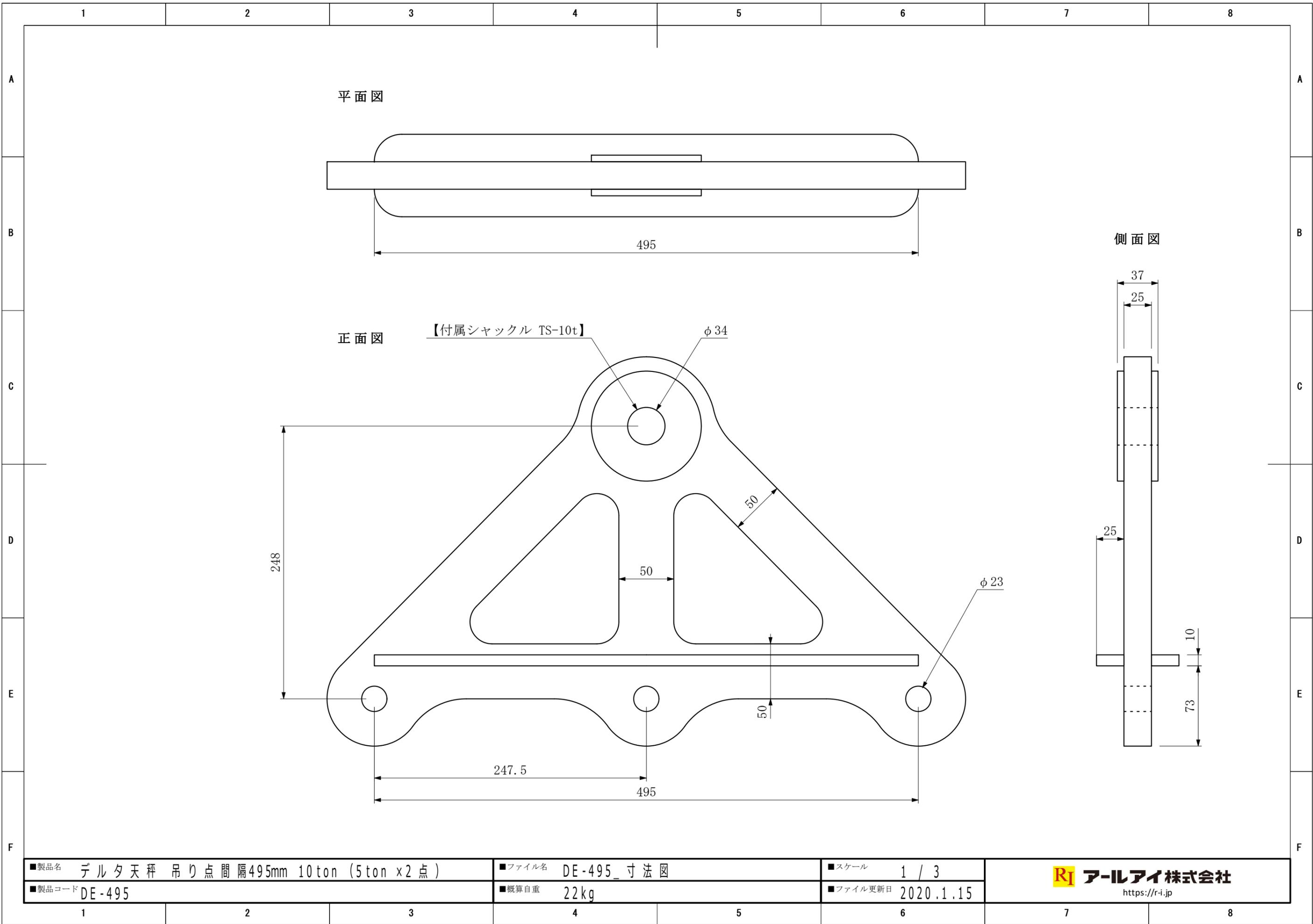
■製品名 デルタ天秤 吊り点間隔495mm 10ton (5ton x2点)
