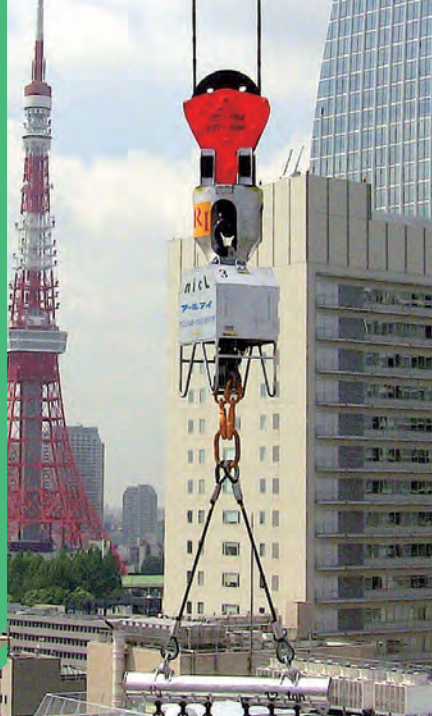
無線操作式回転誘導装置
