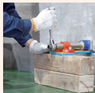
バタ角材等で必ず底面を接地
